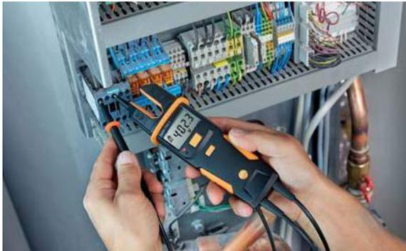
Controllo della tensione su una pompa di calore con **testo 755**.
