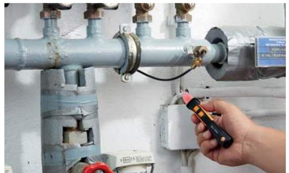
Controllo della tensione su una scatola di derivazione con **testo 745**.
