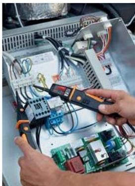
Misura della tensione su compressore.
