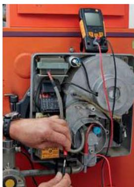
Misurazione della corrente di ionizzazione
